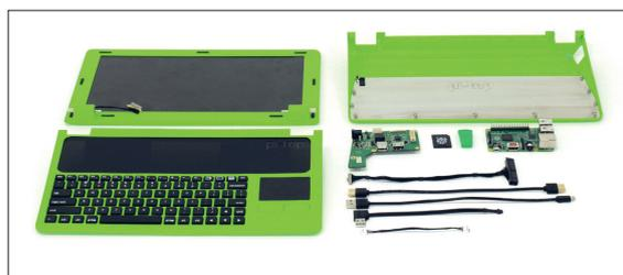
Bild 1. Das Pi-Top Kit von RS Components enthält alle Teile, um den Raspberry Pi zu einem Notebook auszubauen. (Bild: CEED)
